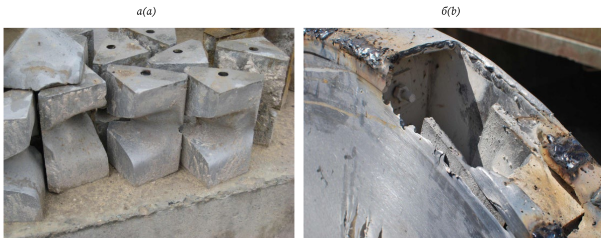
Рис. 1. Изношенный отбойный элемент (а); разрушение лопасти и диска ускорителя (б) при измельчении асфальтового гранулята
