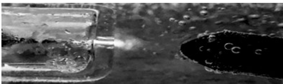
Рис. 3. Внешний вид ПДР в ячейке (свечение желто-красного оттенков локализовалось в растворе в непосредственной близости от диафрагмы)
