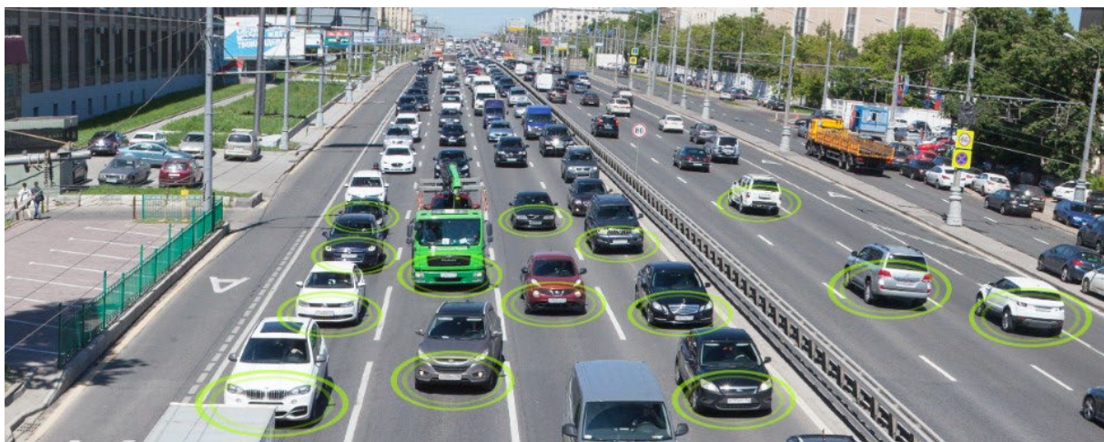
Рис. 2. Отслеживание транспортного потока по средствам камеры [27]
