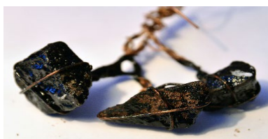
б) Щебень, обработанный добавкой после сушки b) Crushed stone treated with additive after drying
