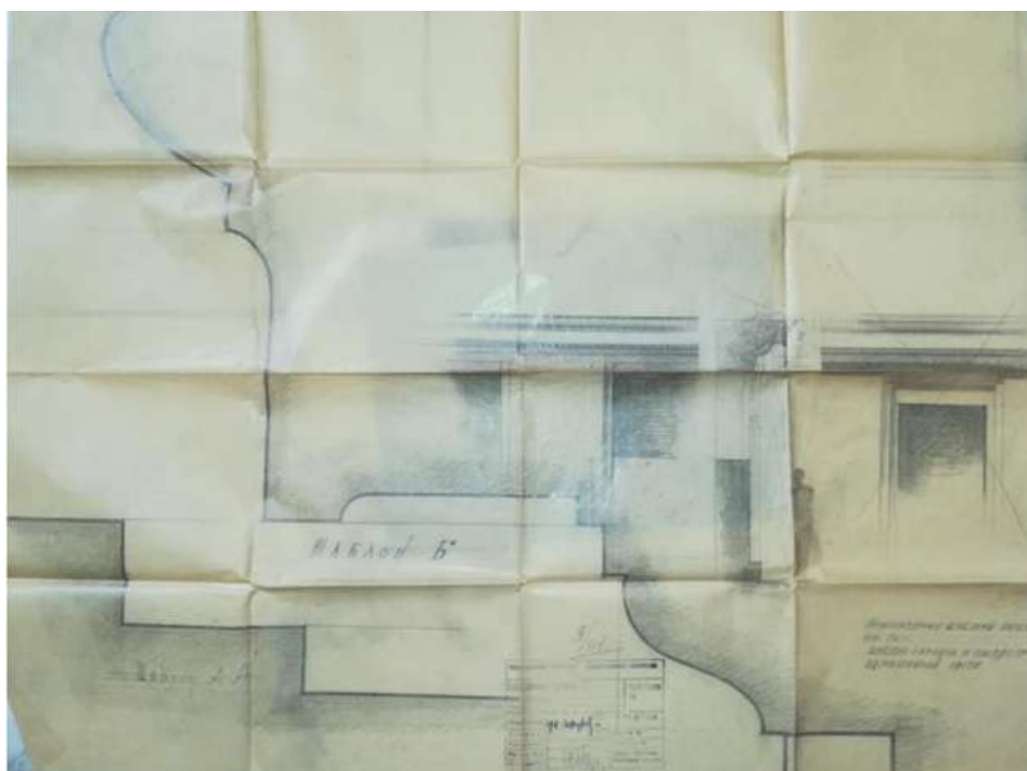
Рис. 13. Архитектурные шаблоны автогаража завода СК-1. Шаблон карниза и пилястр одноэтажной части (архивный чертеж на кальке). Ярославское отделение Ивоблпроектреста. Архитектор И.Н. Дубов [16]
