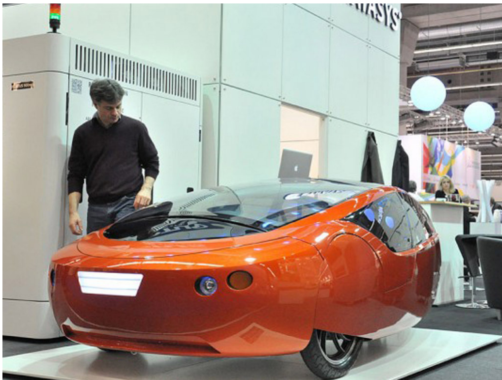
Рис. 5. Автомобиль созданный на 3D-принтере
