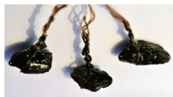
в) Щебень, обработанный добавкой до сушки c) Crushed stone treated with additive before drying
