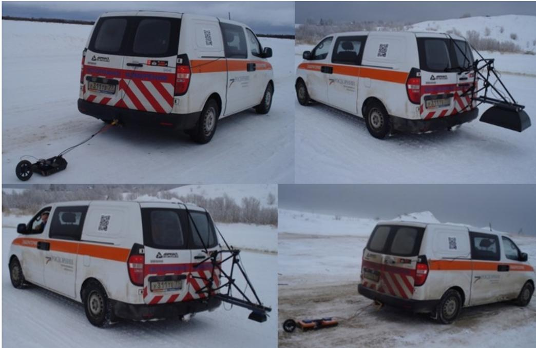
Рис. 3. Дорожная лаборатория с различными антенными блоками (АВ-1700, АВ-400Р, АВ-1700R и АВ-400) на ледовых переправах
