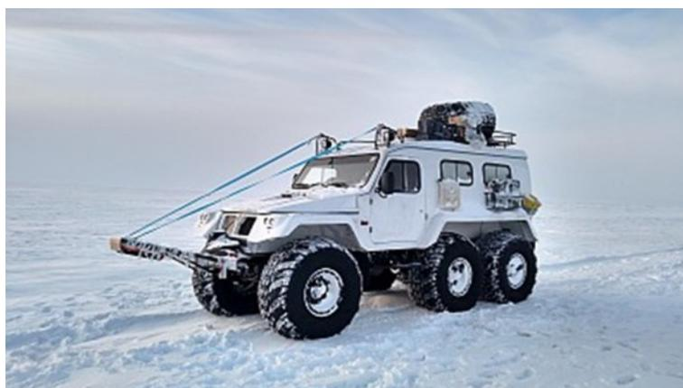
Рис. 6. Общий вид ледомера "ЛД-400"
