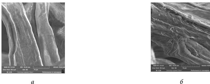
Рис. 6. СЭМ-изображение поверхности сорбентов: a – исходная целлюлоза; б – целлюлоза, модифицированная глицином
