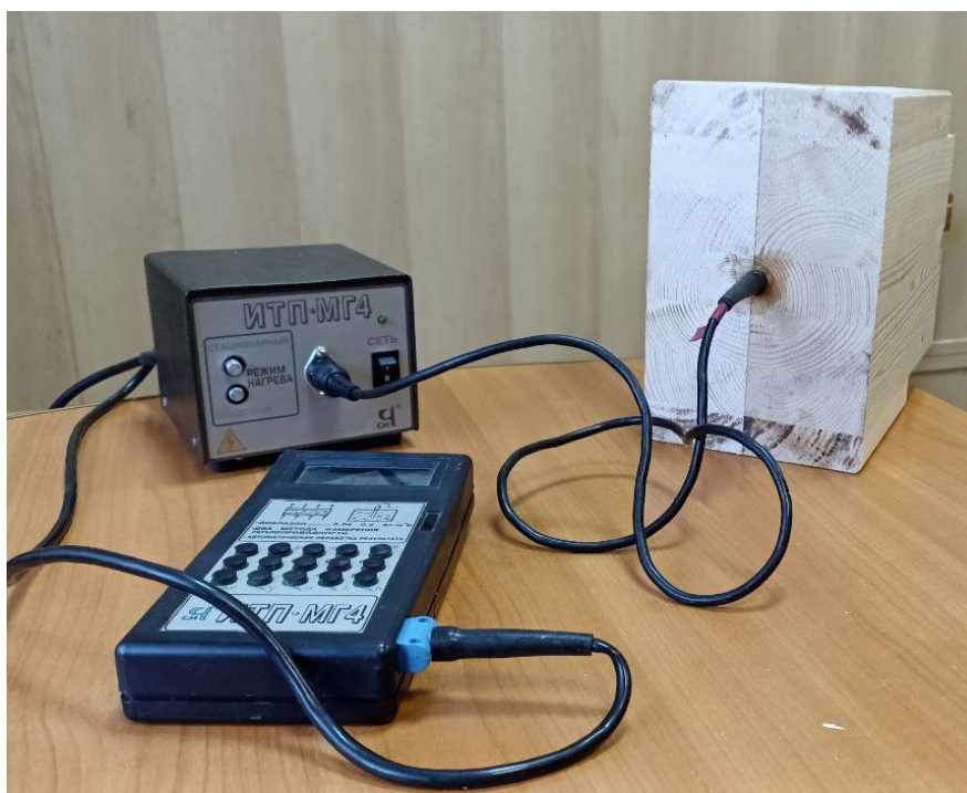
Рис. 2. Измерение коэффициента теплопроводности цилиндрическим зондом Fig. 2. Measurement of the thermal conductivity coefficient with a cylindrical probe
